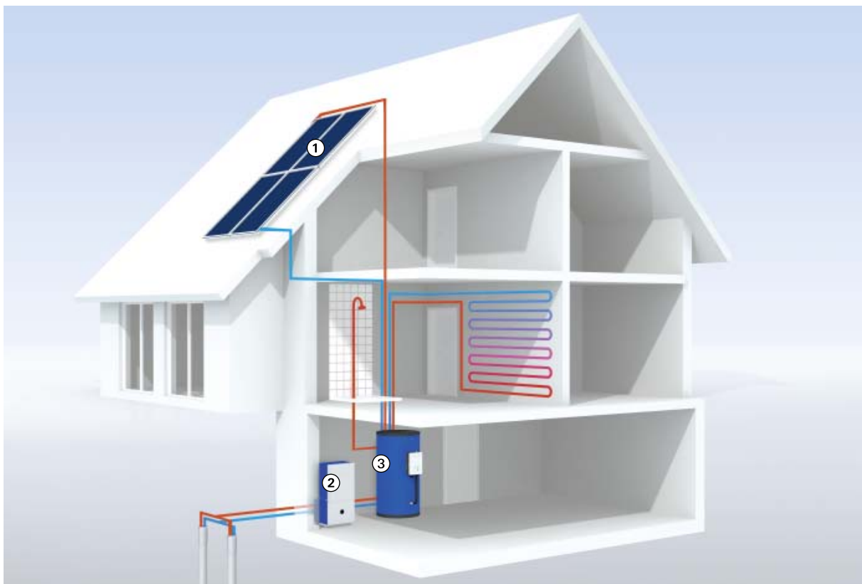
Anlagenschema Sole/Wasser-Wärmepumpe HPSol
