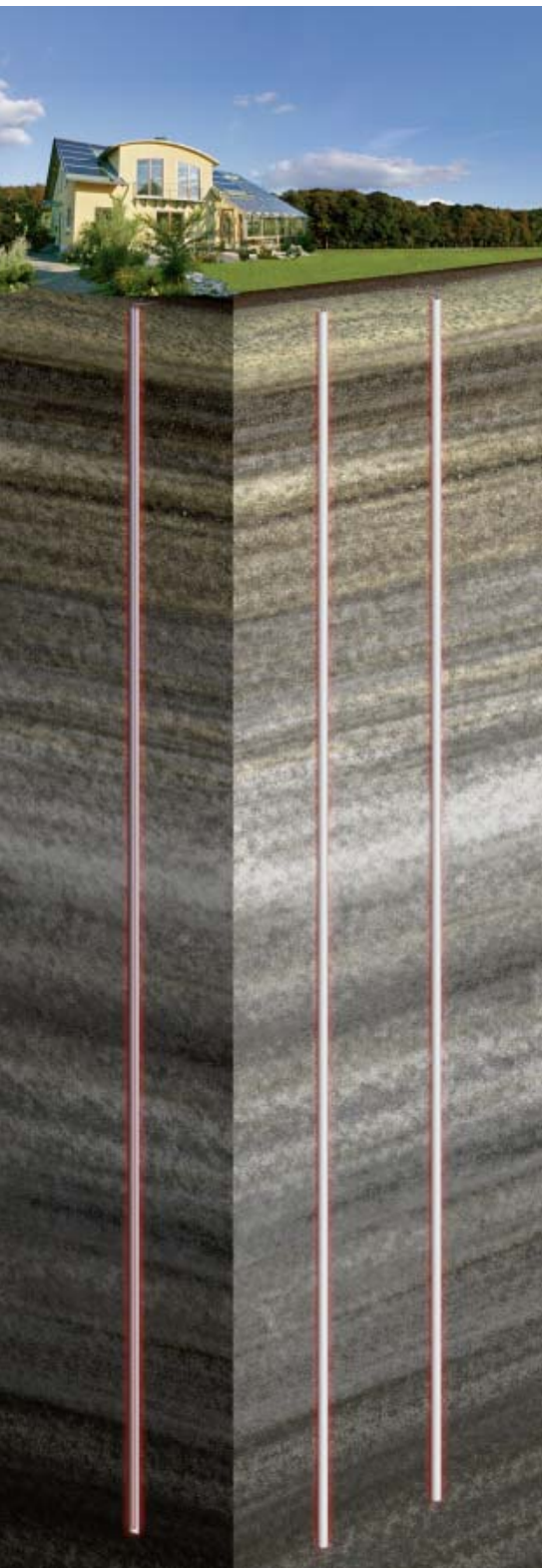
Die Tiefenbohrungen (ca. 100 m) ermöglichen die Nutzung der oberflächennahen Erdwärme
