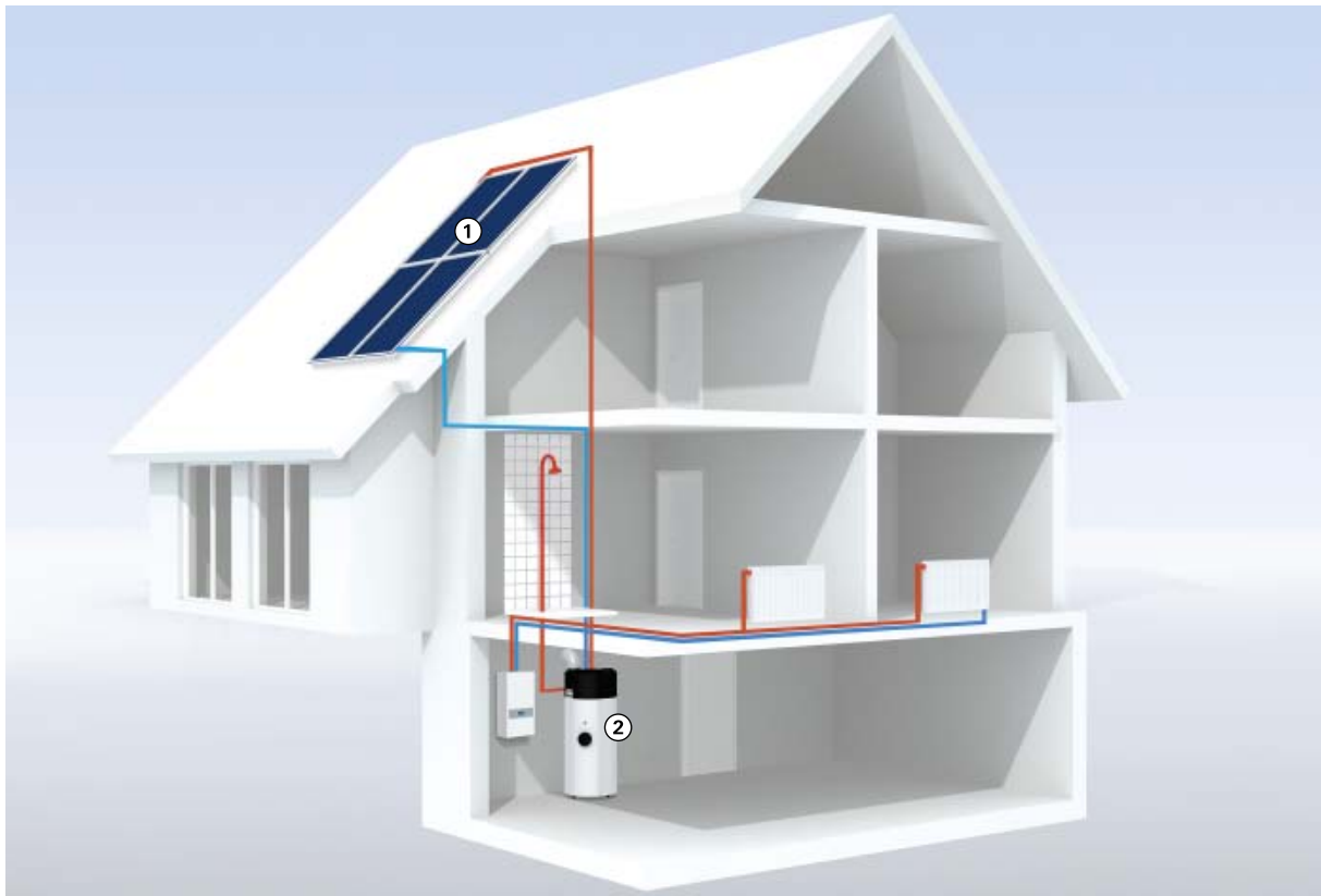
Anlagenschema Raumlufthärmepumpe WPSol 300
